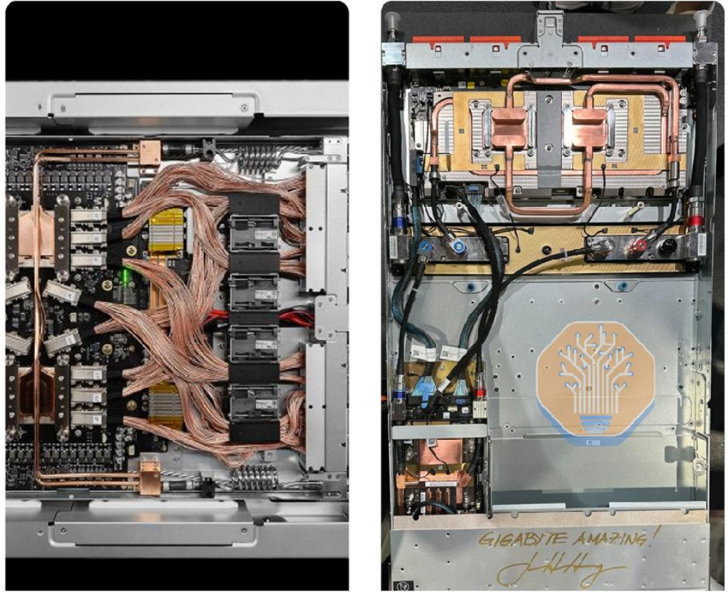
图表 17: GB200/300 柜内计算托盘的架构变化——PCB 逐步替代铜缆
